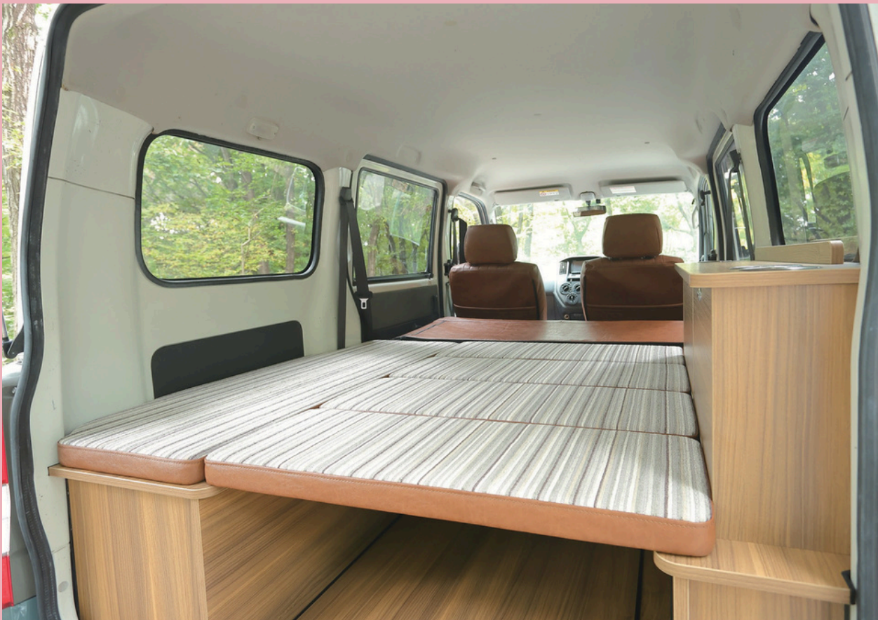
フルフラットモード(フルフラット時:全長1850mm、全幅1260mm)
